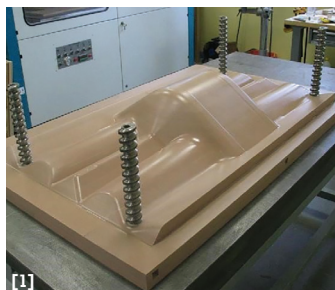
[1] Outillage rapide d'un modèle de formage SPC, en Stratoconception® Résine, pour Aurock. [2] Emballage Pack & Strat® d'une pièce pour Ventana Group.
